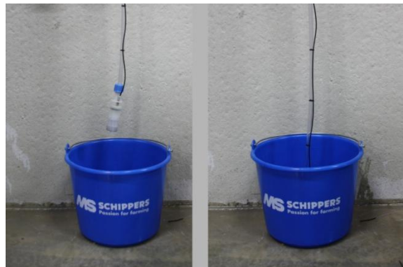
Afbeelding 6: Aanzuigslang in de vloeistof plaatsen
