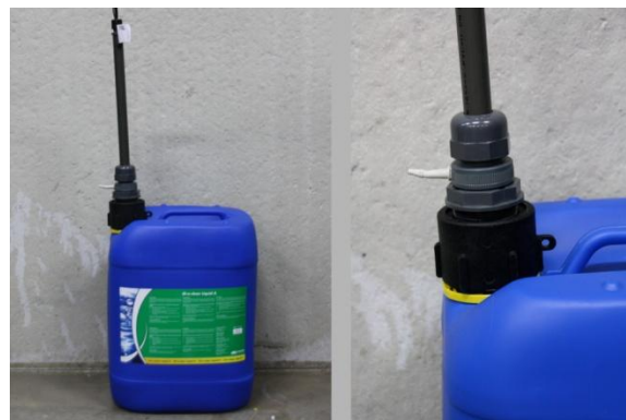
Afbeelding 6: Aanzuiglans op het vat plaatsen
