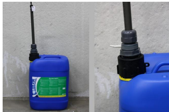
Afbeelding 10: Aanzuiglans op het vat plaatsen
