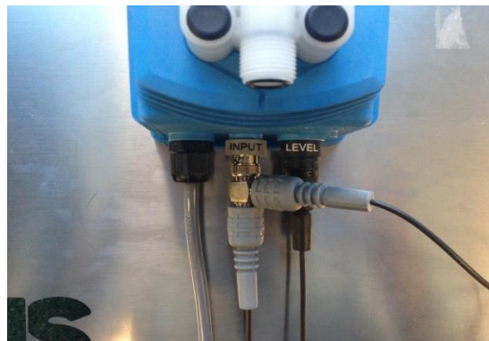
Afbeelding 2: Aansluiten droogloopbeveiliging en waterteller
