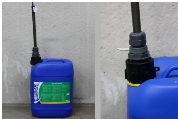
Afbeelding 10: Aanzuiglans op het vat plaatsen
