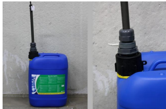
Afbeelding 10: Aanzuiglans op het vat plaatsen
