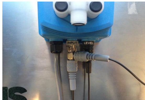
Afbeelding 2: Aansluiten droogloopbeveiliging en waterteller
