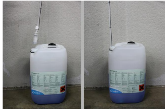
Afbeelding 14: Aanzuigslang in de vloeistof
